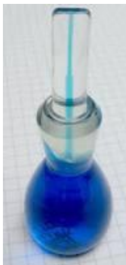
Fig. No. 1 Llenado correcto del picnómetro
